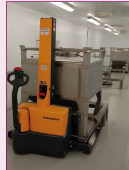
De rvs IBC wordt op het bordes met een handpallettruck op het dockingstation gezet; op de achtergrond een leeg dockingstation en een aangekoppelde IBC.
