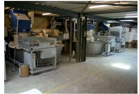
Alle mengers bij Twilmij zijn voorzien van een losstation voor de UCON-containers
