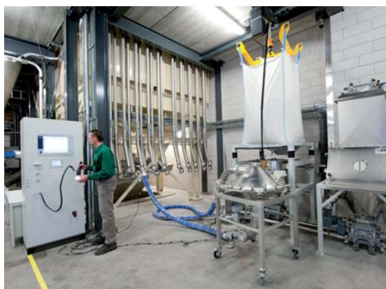
De kleincomponenten worden voor inname middels een FIBC-losstation of zakkenstortkabinet (rechts) eerst met behulp van een NIR-analyser (links) geïdentificeerd
