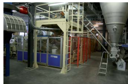
Vanuit de Vrieco Nauta-mengers gaat het product middels een aero-mechanische transporteur naar de afvullijnen van Ausloos Verpakkingstechniek
