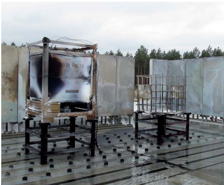
Afb. 2 Het resultaat na 30 minuten blootstelling aan vuur: de metalen IBC links is ondanks enige vervorming nog volledig intact, van de kunststof IBC rechts is slechts het geraamte over
