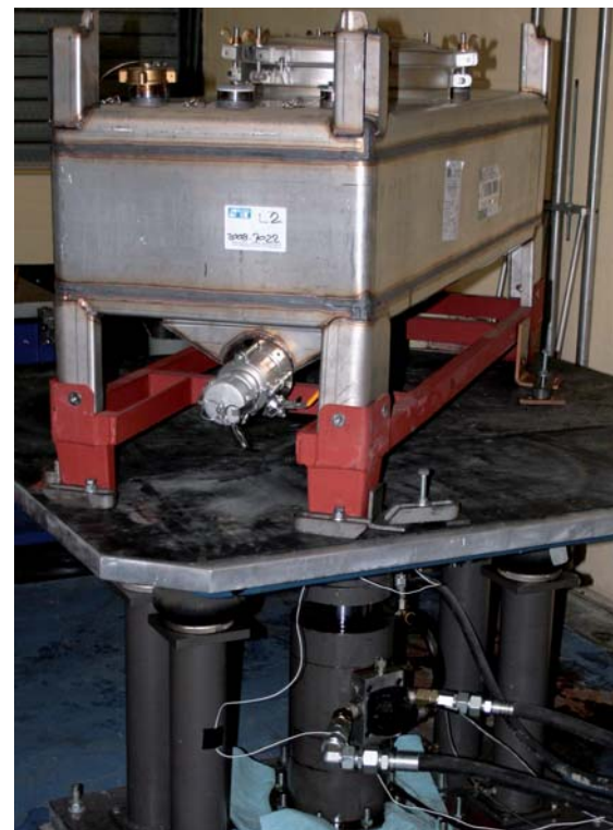
Afb. 3 Opstelling voor een vibratietest
