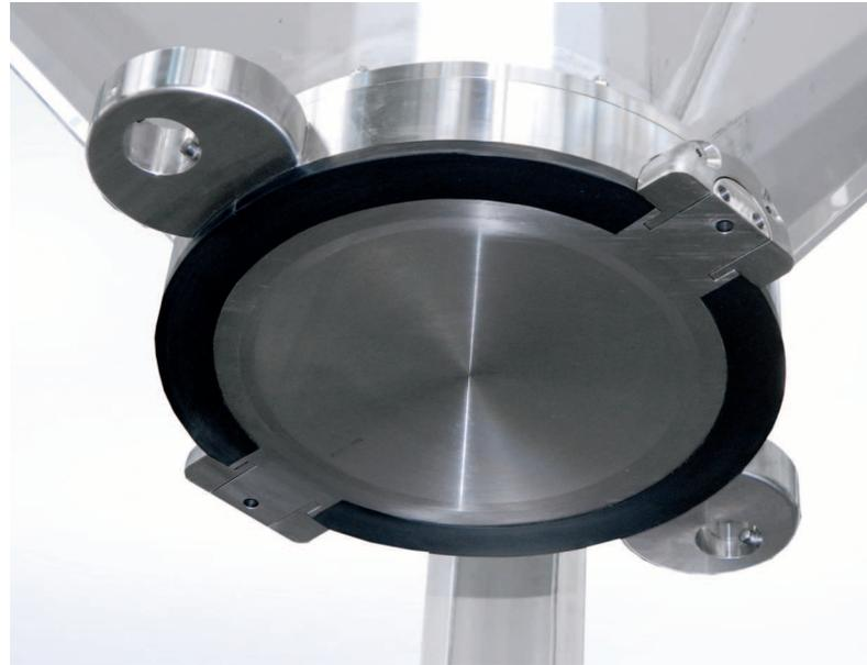
*Staubfreie Entleerung mit Doppelklappensystem*
